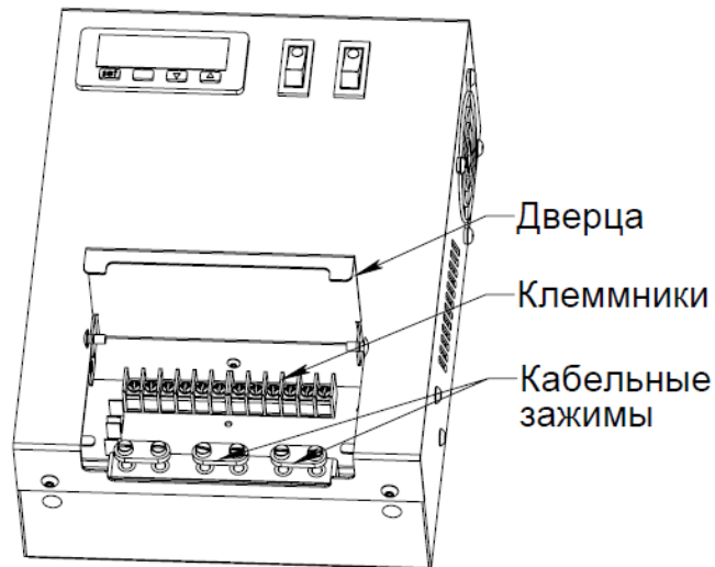
Рис.3.2а. Общий вид шкафа управления
